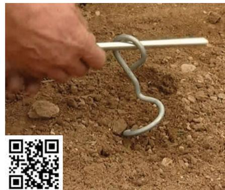
Ancrage tire bouchon récupérable. Scanner pour visionner la vidéo.
